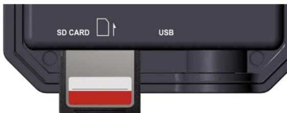
Abb. 7: Einsetzen der SD-Karte
